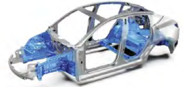
Abbildung 8: Vergleich klassischer Karosseriebau und Mega-Casting Quelle: S&P Global Mobility, 2023
