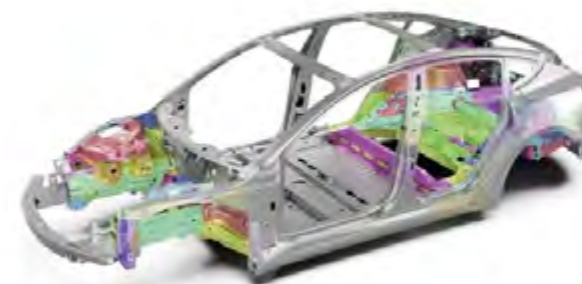
Abbildung 8: Vergleich klassischer Karosseriebau und Mega-Casting Quelle: S&P Global Mobility, 2023
